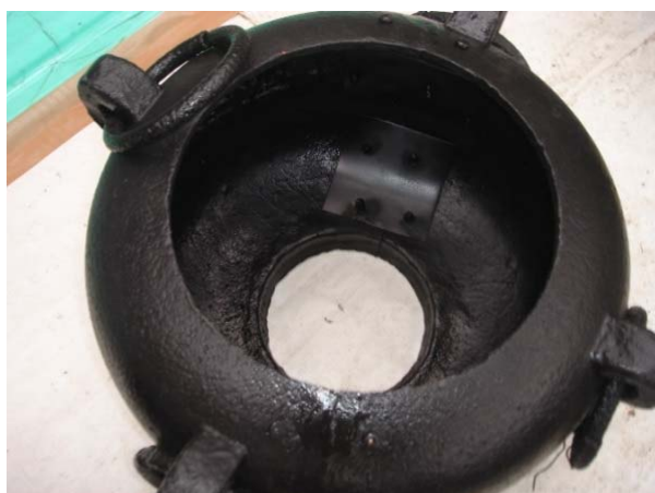
色直し及び、内部欠損補強
